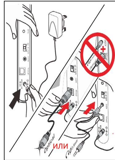
2. Вставьте один конец кабеля с разъемом 3,5 мм в аудиоразъем на задней панели зарядного устройства, либо один конец оптического кабеля в оптический разъем на задней панели зарядного устройства.
