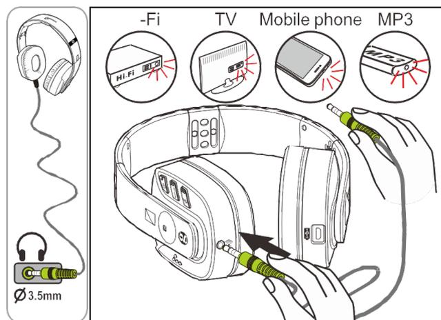
Вставьте одну сторону разъема для кабеля 3,5 мм (штекер) в разъем "Аудио", расположенный в нижней части гарнитуры. Вставьте другую сторону разъема 3,5 мм в гнездо аудиовыхода вашего Hi-fi, мобильного телефона, телевизора или MP3-плеера.
