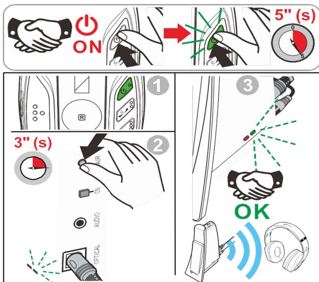
Заводские настройки предполагают автоматическое сопряжение гарнитуры с зарядной станцией. Распознавание происходит автоматически при включении гарнитуры. Однако, если по какой-либо распознавания не происходит, то для сопряжения двух устройств необходимо выполнить очень простую процедуру:
